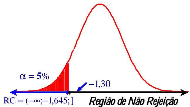
A significância do resultado obtido (-1,30), isto é, o valor-p é:  $p = P(Z < -1,30) = \Phi(-1,30) = \text{DIST.NORMP}(-1,30) = 9,68\%$ .
