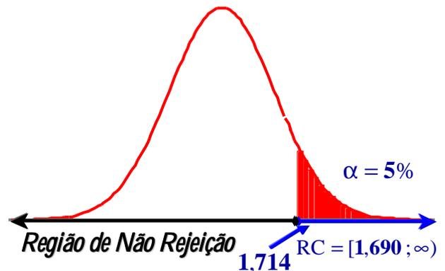
A significância do resultado obtido (1,714), isto é, o valor-p é  $P(T_{35} > 1,714) = DISTT(1,714; 35; 1) = 4,77\%$
