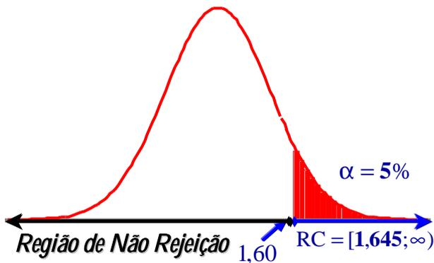
A significância do resultado obtido (1,60), isto é, o valor-p é  $P(Z > 1,60) = P(Z > 1,60) = 1 - \Phi(1,60) = \Phi(-1,60) = 5,48\%$ .
