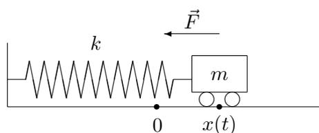
formado por uma massa  $m$  presa a uma mola de constante de elasticidade  $k$  e que realiza oscilações livres (sem força externa), não amortecidas (sem atrito) em torno de uma posição de equilíbrio. Colocamos a coordenada 0 na posição de equilíbrio. Em cada instante  $t$  a massa ocupa a posição de abscissa  $x = x(t)$ . A única força que age sobre a massa é a
